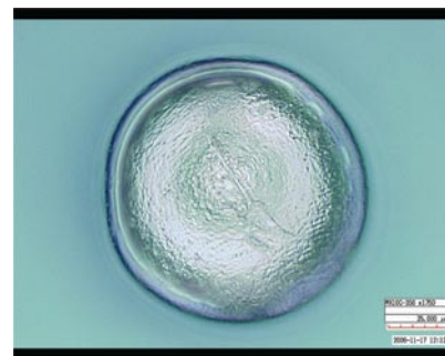
Рис. 17. Блестящие паяные соединения после отмычки жидкостями Кузен
