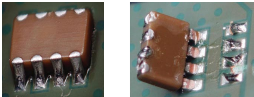
Рис. 5. Не удаленные остатки флюса под корпусом компонента
