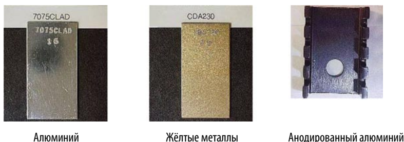
Рис. 16. Совместимость промывочных жидкостей Кузен с различными металлами. Результаты испытаний. Отсутствие коррозии после продолжительного химического воздействия
