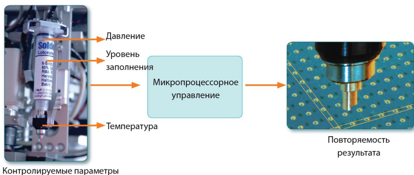
Рис. 18. Схема работы системы дозирования паяльной пасты или клея
