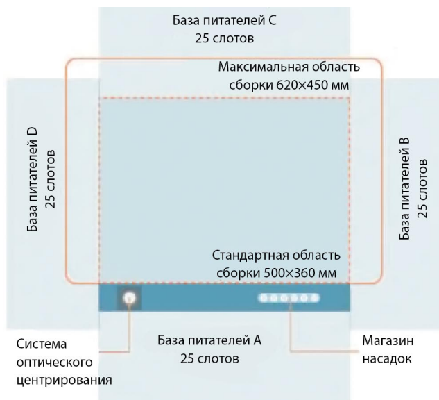
Рис. 2. Схема рабочих областей автомата placeAll 510
